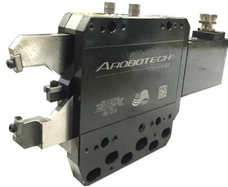
Reparierte / Aufbereitete Lünette
